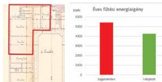
Ábra 5., 6.: A szimulációk során vizsgált társasházi lakás (bal), illetve az éves fűtési energiaigény változása (jobb).
