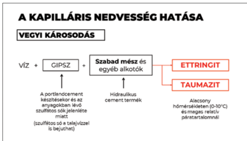
1. ábra: Ettringit és taumazit képződése
