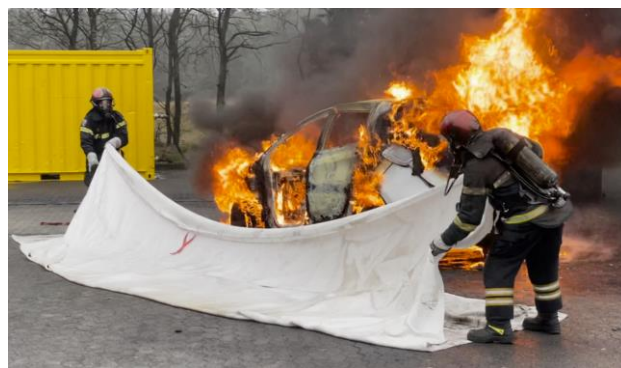
9-10 sz. képek. Tűzoltó takaró és alkalmazása. Forrás: Fire Isolator, www.fireisolator.com
