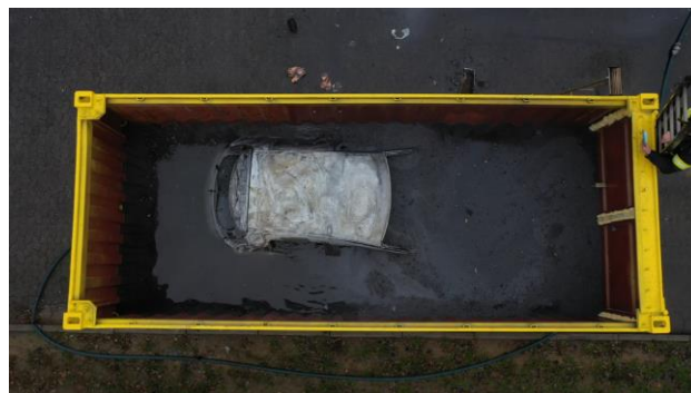
11-12 sz. képek. Tűzoltó konténer és alkalmazása. Forrás: Fire Isolator, www.fireisolator.com
