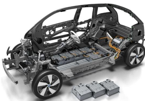
1-2 sz. képek. Közepes és nagy hatótávolságú elektromos jármű alváza és hajtáslánca (balra: BMW i3, jobbra: VW ID3)
