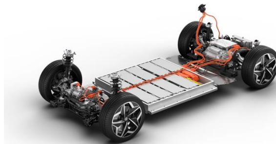
1-2 sz. képek. Közepes és nagy hatótávolságú elektromos jármű alváza és hajtáslánca (balra: BMW i3, jobbra: VW ID3)
