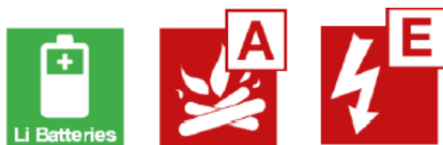
20 sz. kép. Lítium ion akkumulátortűz oltására megfelelő kézi oltókészülék jelölése
