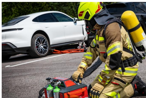
13-14 sz. képek. Tűzoltó tűske és alkalmazása. Forrás: Rosenbauer
