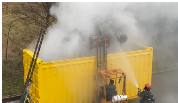
11-12 sz. képek. Tűzoltó konténer és alkalmazása. Forrás: Fire Isolator, www.fireisolator.com
