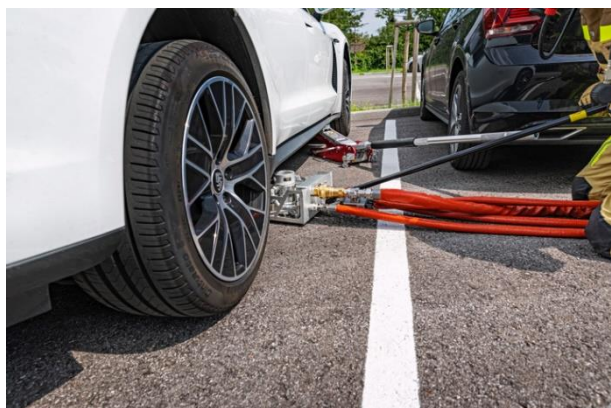
13-14 sz. képek. Tűzoltó tűske és alkalmazása. Forrás: Rosenbauer
